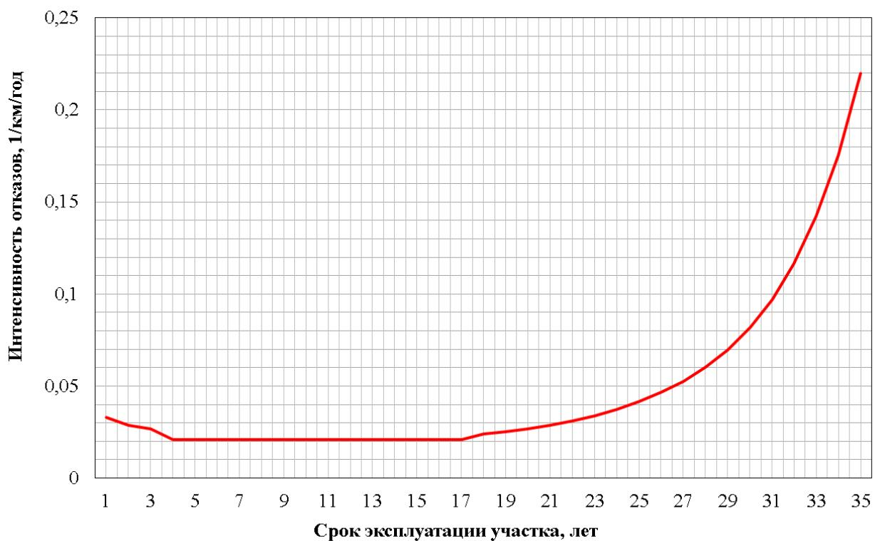
**Рисунок 7 – Интенсивность отказов в зависимости от срока эксплуатации участка тепловой сети**
