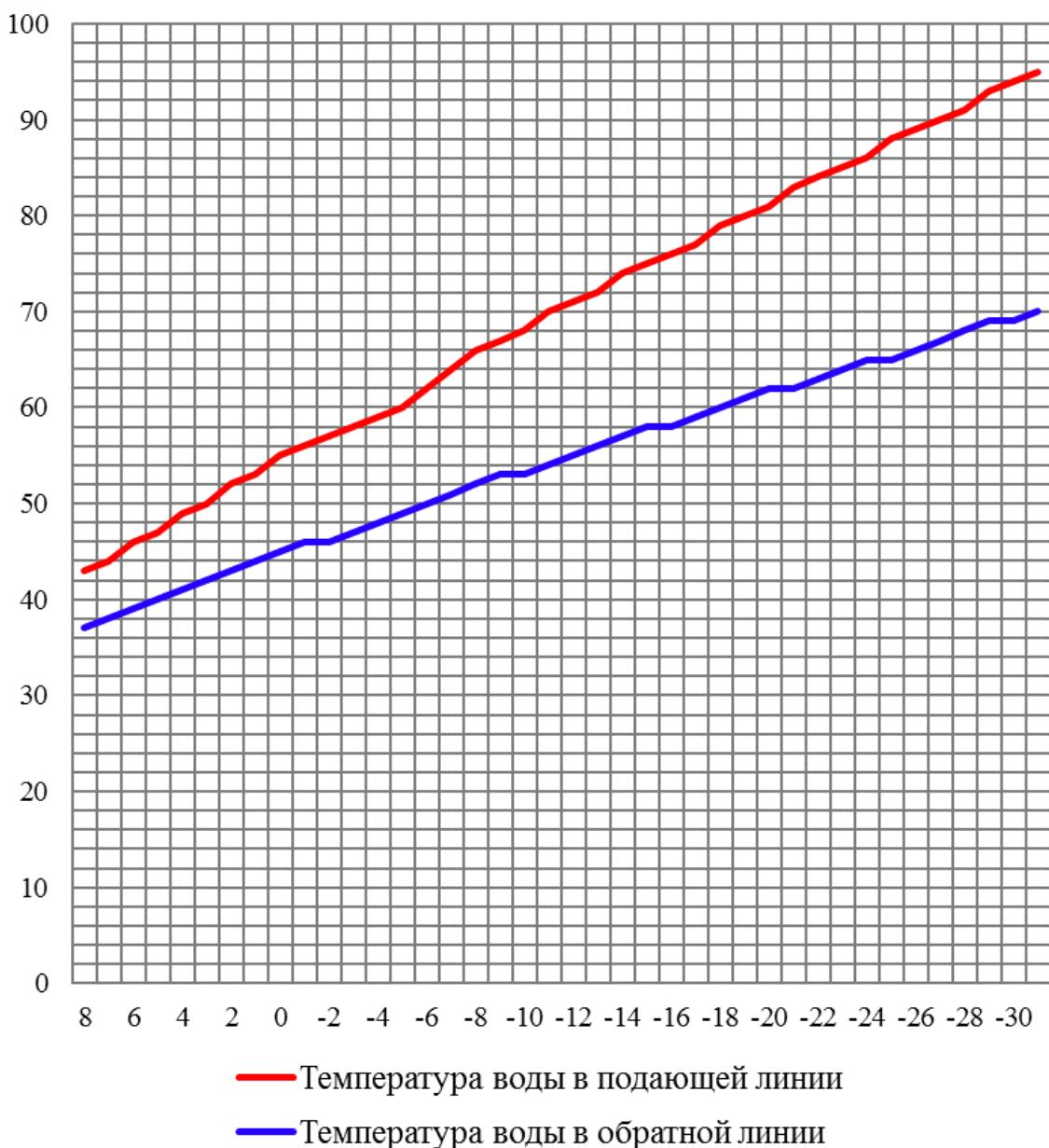
**Рисунок 4 – Графическое представление температурного графика**
