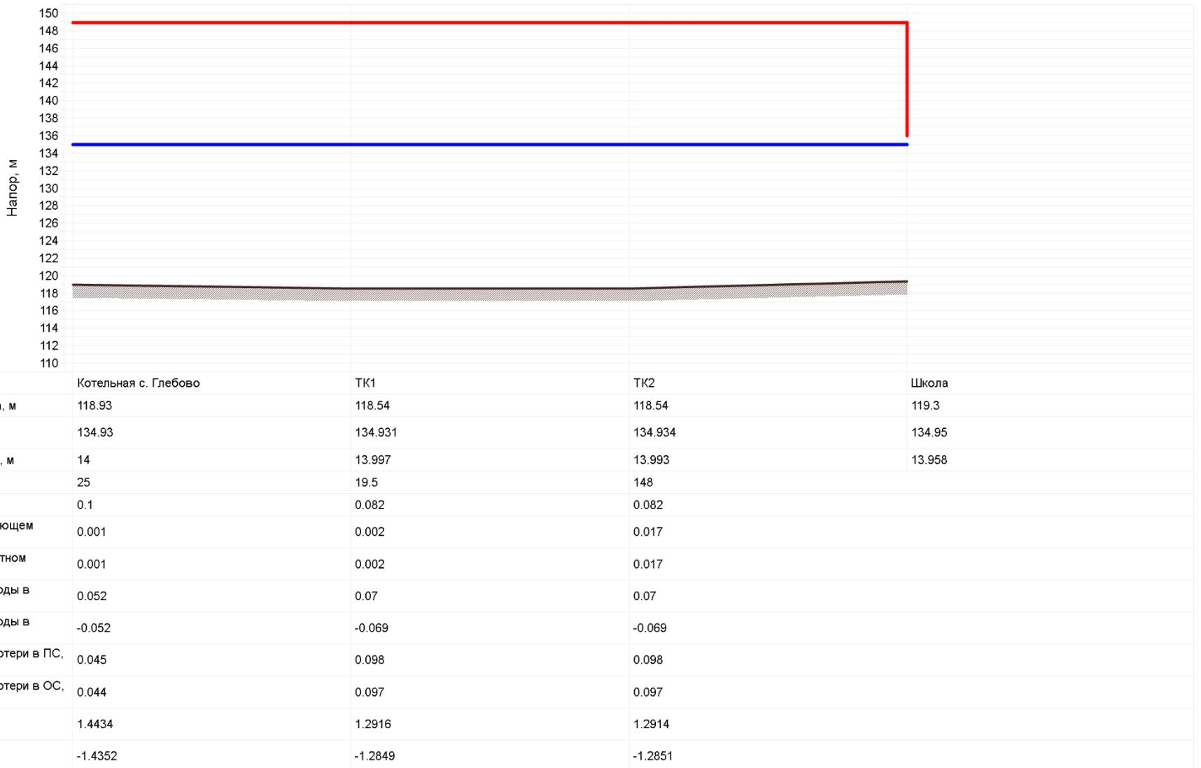
**Рисунок 6 – Пьезометрический график от котельной с. Глебово**
