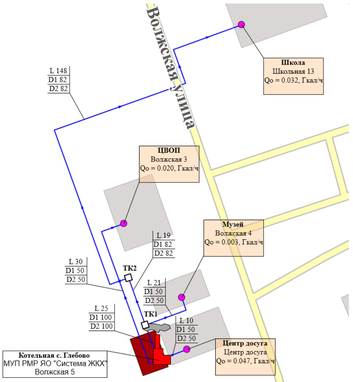
1.3.3 Параметры тепловых сетей, включая год начала эксплуатации, тип изоляции, тип компенсирующих устройств, тип прокладки, краткую характеристику грунтов в местах прокладки с выделением наименее надежных участков, определением их материальной характеристики и подключенной тепловой нагрузки
